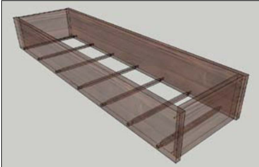
Afbeelding 5.14. Reconstructie van de bouwwijze van een grafkist met een lattenbodem. Bron: Hos en Dorst, 2010.
